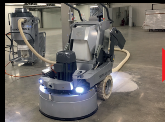
LAVINA FLOOR Technologia zdzierania, szlifowania i polerowania betonu, kamienia przy pomocy ciężkich maszyn planetarnych.
